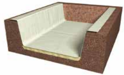
Step 3 - Lay geotextile / membrane.
