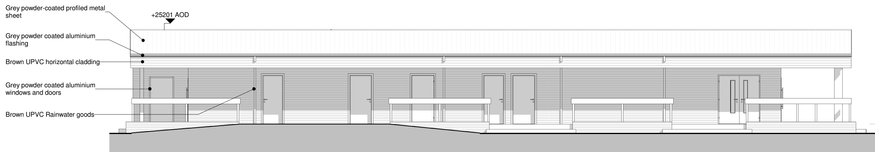
5 NE Elevation - Existing Scale: 1 : 100
